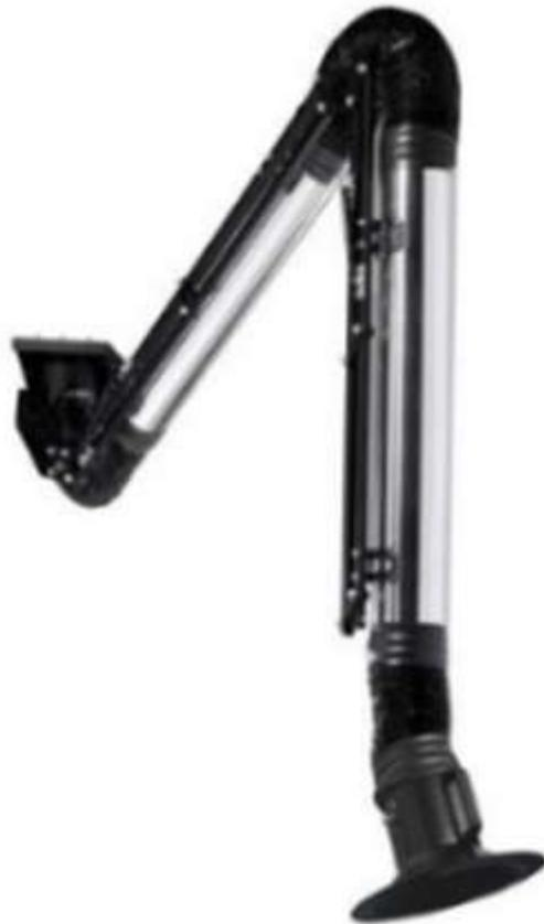
Die Abzugshaube hat ein quadratisches Profil, um eine maximale Saugleistung zu gewährleisten; sie ist außerdem mit einem manuellen Dämpfer für die Kalibrierung der Durchflussmenge, einem Schutzgitter gegen Eindringen und einem Griff ausgestattet. Die Wandausführungen sind mit einem lackierten Stahlboden zur Befestigung und zum Anschluss an das Rauchabzugsrohr ausgestattet.
